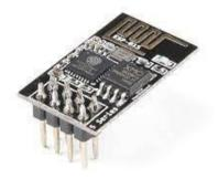
Figure 2.6Wi-Fi module<sup>6</sup>
