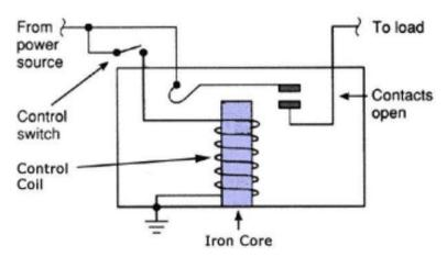
Figure 2.2 SPDT Relay <sup>2</sup>
